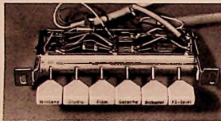
Bild 7. Bild- und Klangregistereinheit der neuen Nordmende-Fernsehempfänger
