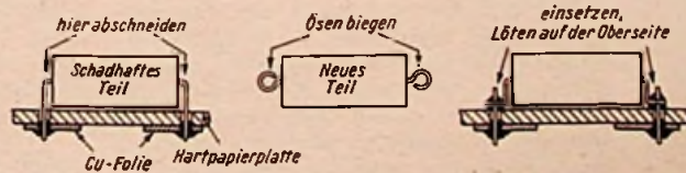
Bild 3. Austausch schadhafter Kleinteile bei einer gedruckten Schaltung
