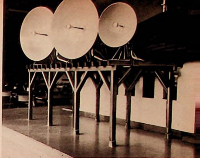
Bild 1. Das südliche Antennenpodest der Modellanlage mit den Metallmodellen der Parabolantennen (links und Mitte: Freda und PPM in Richtung Fleckertshöhe/Feldberg, rechts: Freda in Richtung Koblenz)
