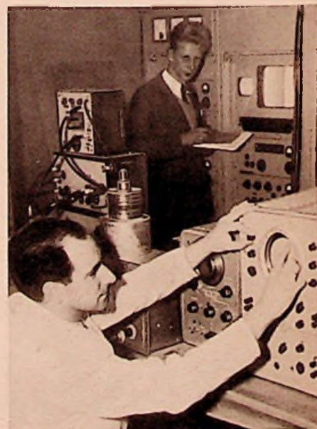
Die deutschen Ingenieure W. von Seckondorf (vorn) und M. Knof bei der Endprüfung des Siemens-Fernsehsenders GTV-9 in Melbourne
