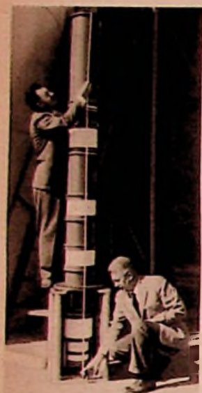
Über drei Meter lang ist dieses stärkste Klystron der Welt
